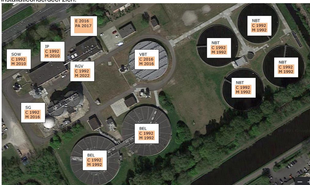
Afb. 5.8.4.4.1: Bouwjaar per installatieonderdeel
