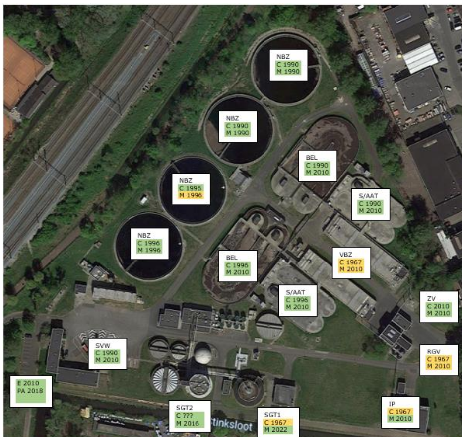
Afb. 5.8.3.3.1: Bouwjaar per installatieonderdeel
